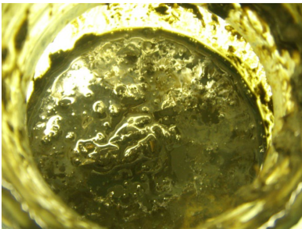
Figuur 11 Ruw digestaat met mest (droge stof gehalte van \pm 10\% ) – as such, te mixen voorafgaandelijk aan deelmonsternamen
