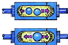
Figuur 9: Kogeltrilmolen – horizontale beweging (Mixer mills)
