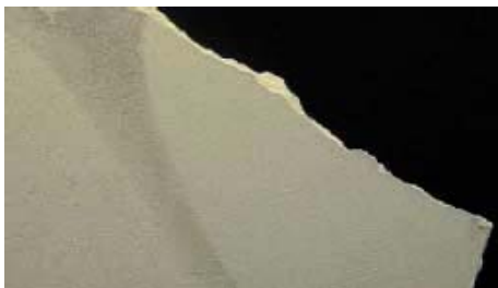
Figuur 5 en Figuur 6: breukvlak met fijnere vezels (asbestvrij)
