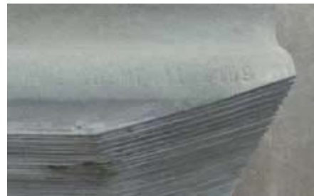
Figuur 2: golfplaten, asbestvrij
