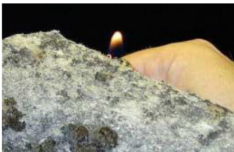
Figuur 7: opgloeiende asbestvezel
