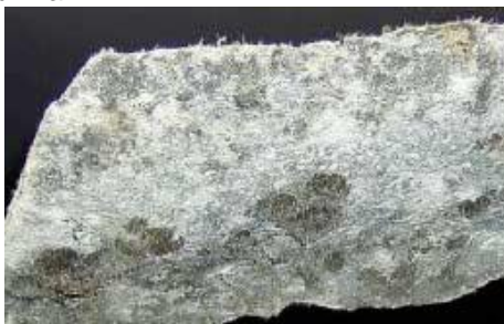
Figuur 3 en Figuur 4: breukvlak met asbestvezels
