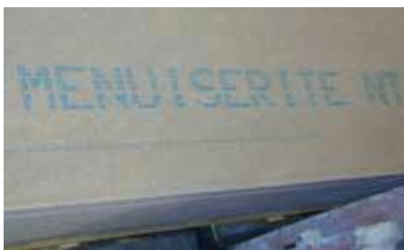
Figuur 1: menuiserite, asbestvrij
