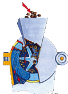
Figuur 23: Slagrotormolen (Rotor beater mill)
