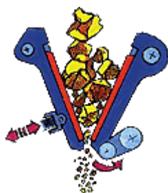
Figuur 6: Kaakbreker (jaw crusher)
