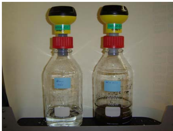
Figuur 1: Foto van een gesloten respirometer met drukmeetekop en adapter
