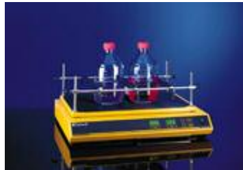
Figuur 21: Schudtafel met heen- en weergaande beweging
