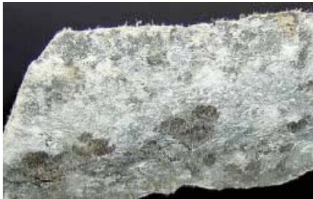
Figuur 3 en Figuur 4: breukvlak met asbestvezels
