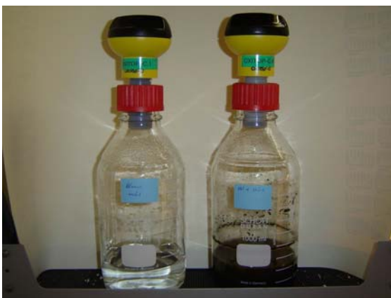
Figuur 1: Foto van een gesloten respirometer met drukmeetkop en adapter
