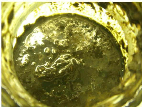
Figuur 10 Ruw digestaat met mest (droge stof gehalte van \pm 10\% ) – as such, te mixen voorafgaandelijk aan deelmonsternamen
