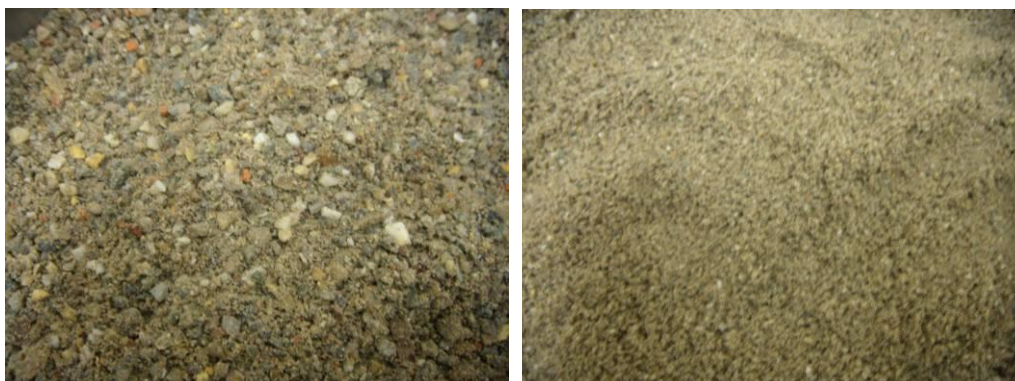
Figuur 3 Links: Gemalen betonpuin < 4 mm; Rechts: gemalen betonpuin < 1 mm
