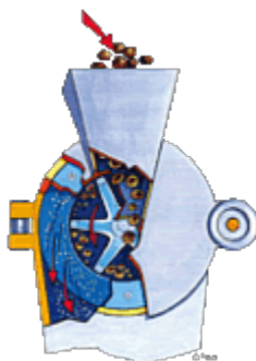
Figuur 23: Slagrotormolen (Rotor beater mill)
