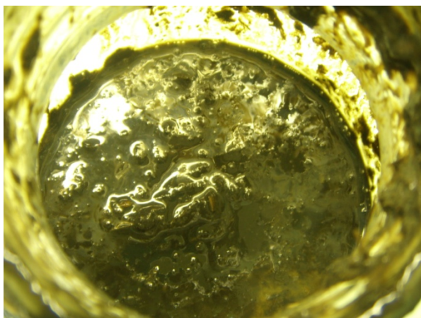
Figuur 12 Ruw digestaat met mest (droge stof gehalte van \pm 10\% ) – as such, te mixen voorafgaandelijk aan deelmonsternamen
