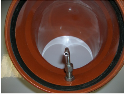
Figuur 14: Opzetstuk met aanzuigmond voor rechtstreekse aankoppeling van een verwarmde leiding zonder aanzuigsonde
