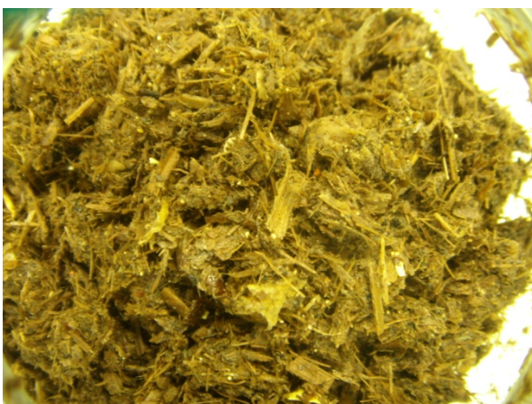
Figuur 6 Dikke fractie digestaat zonder mest - homogenisatie door omzetten
