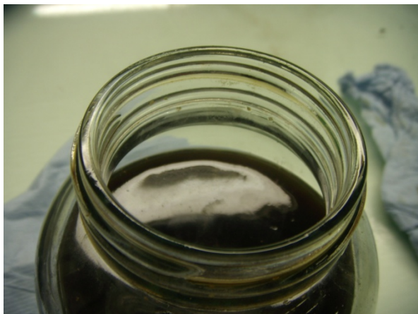
Figuur 15 Effluent na biologie mest+digestaat (droge stof gehalte van \pm 1\% )
