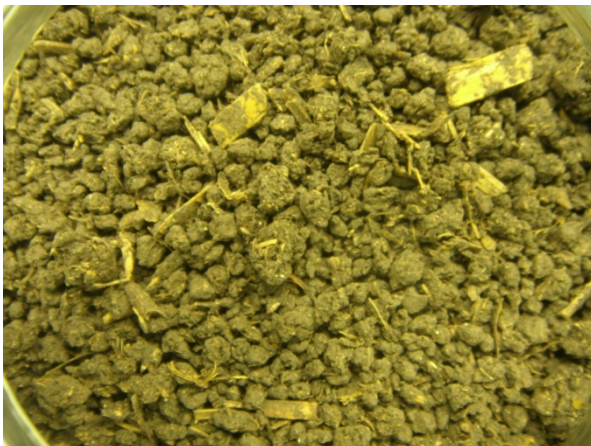
Figuur 5 Gedroogd digestaat met mest - homogenisatie door omzetten
