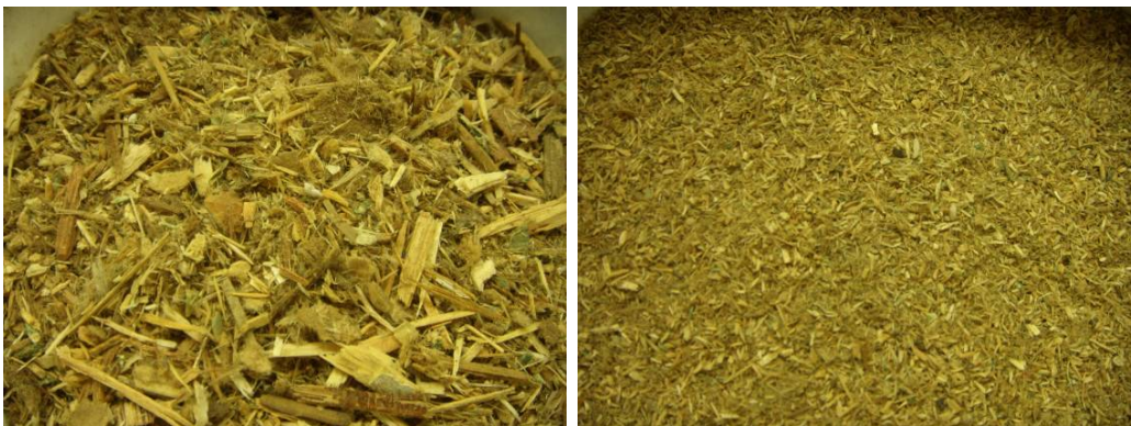
Figuur 2 Links: Houtafval (0-15 mm); Rechts: Verkleind < 2 mm
