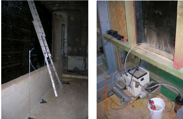
Figuur 7: NH 3 -metingen in de ventilatielucht aan de ingang van de luchtwasser
