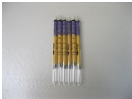
Figuur 3: Gasdetectiebuisjes voor homogeniteitscontrole van het oppervlak van de luchtwasser
