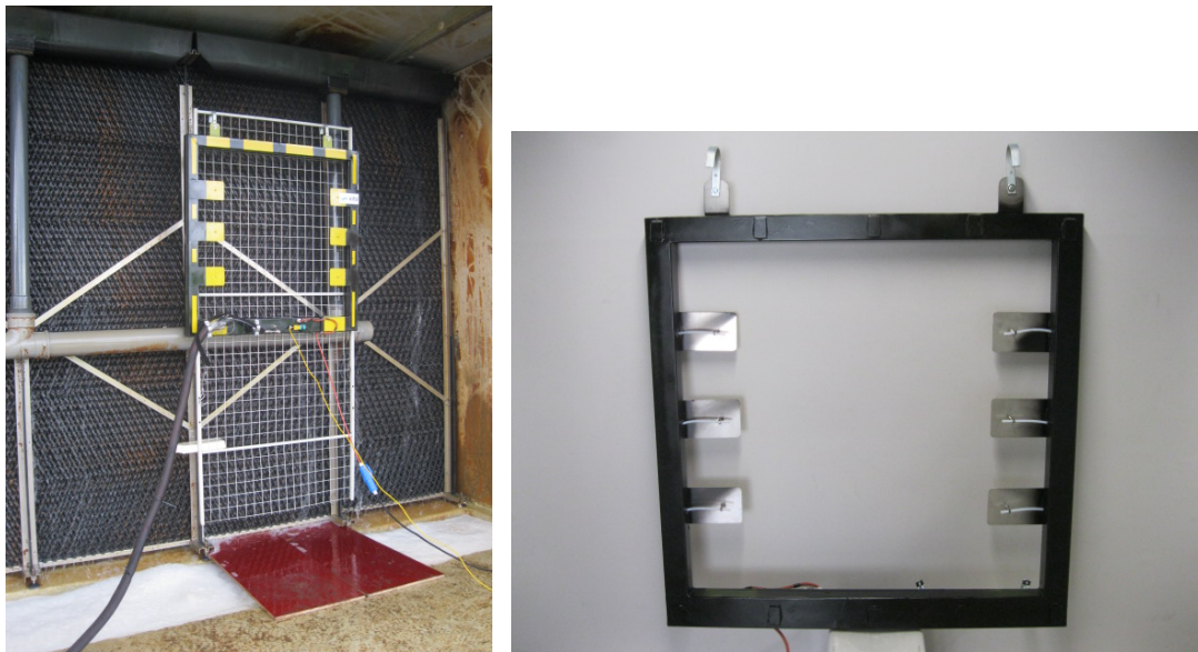
Figuur 12: Rooster voor simultane monsterneming op verschillende meetpunten van een groter deeloppervlak
