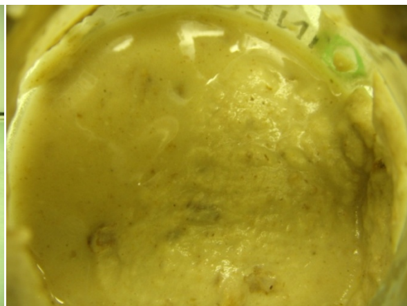
Figuur 7 Aardappelzetmeel - homogenisatie na uitspreiden in schaal
