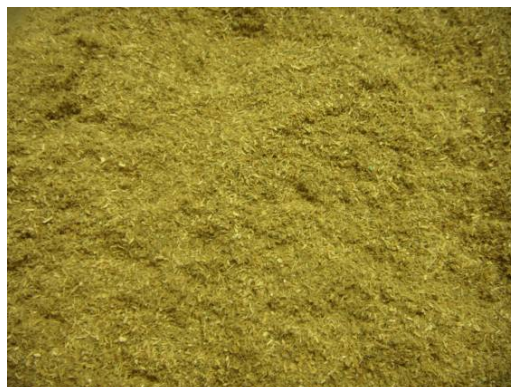
Figuur 3: Houtafval verkleind < 1 mm
