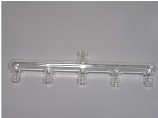
Figuur 10: Voorbeeld van een glazen verdeelstuk voor monsterneming van de ventilatielucht op verschillende plaatsen vóór de luchtwasser
