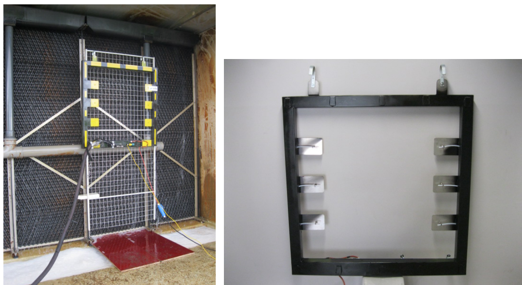
Figuur 12: Rooster voor simultane monsterneming op verschillende meetpunten van een groter deelopervlak
