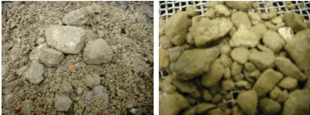
Figuur 2 Links: Betonpuin (0-20 mm); Rechts: zeefrest betonpuin groter dan 4 mm
