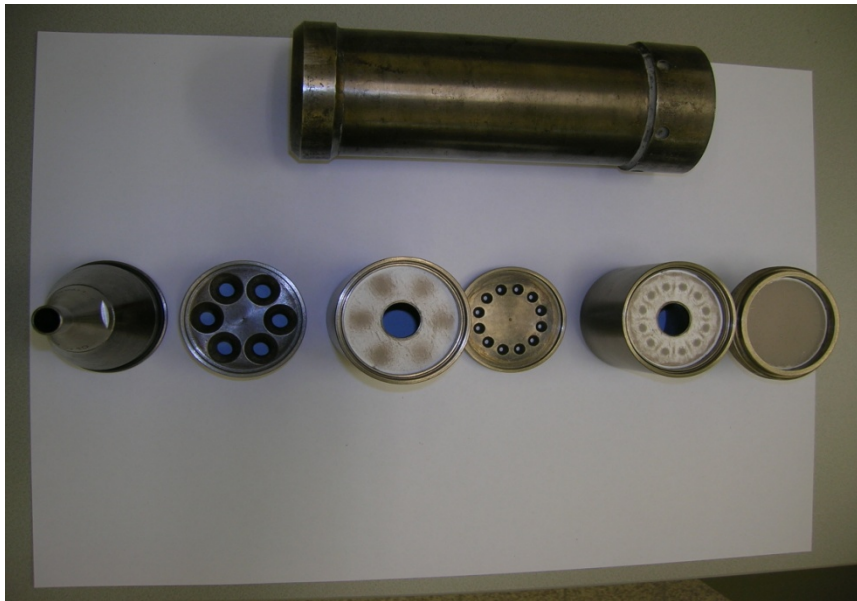
Figuur 3: Afbeelding van een tweetraps impactor, met de inlaatnozzle, de nozzleplaten, de impactorplaten en de back-up filter
