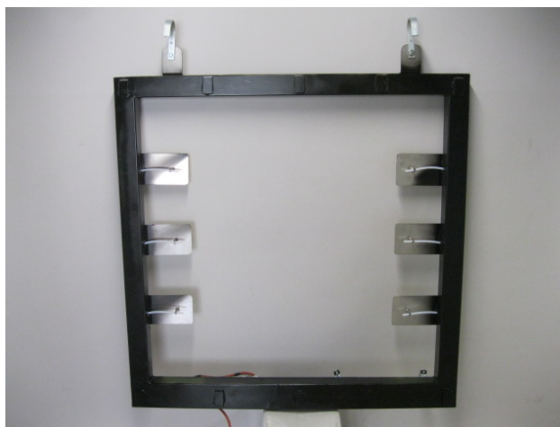
Figuur 12: Rooster voor simultane monsterneming op verschillende meetpunten van een groter deelopervlak
