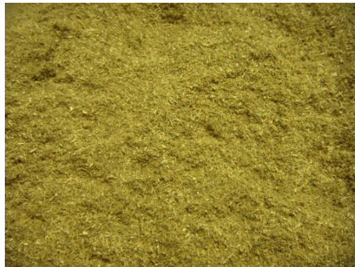
Figuur 3: Houtafval verkleind < 1 mm
