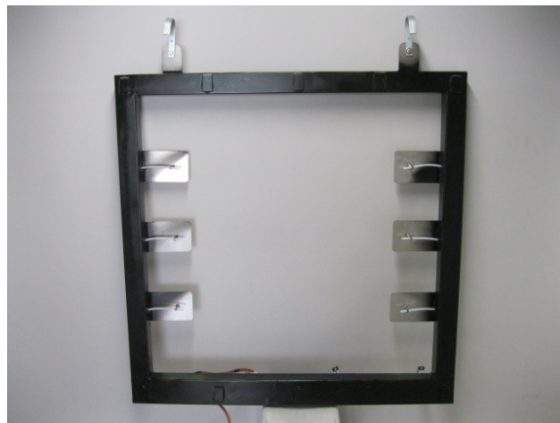
Figuur 12: Rooster voor simultane monsterneming op verschillende meetpunten van een groter deelopervlak
