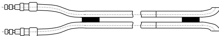
Figuur 3: S-type Pitotbuis en oriëntering in de gasstroom
