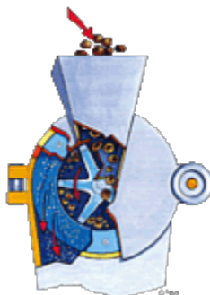
Figuur 23: Slagrotormolen (Rotor beater mill)
