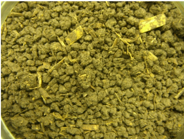
Figuur 4 Gedroogd digestaat met mest - homogenisatie door omzetten
