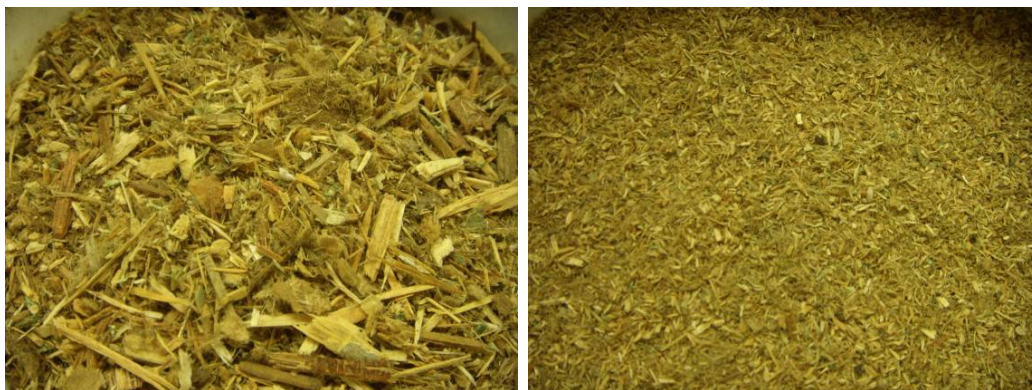
Figuur 2 Links: Houtafval (0-15 mm); Rechts: Verkleind < 2 mm
