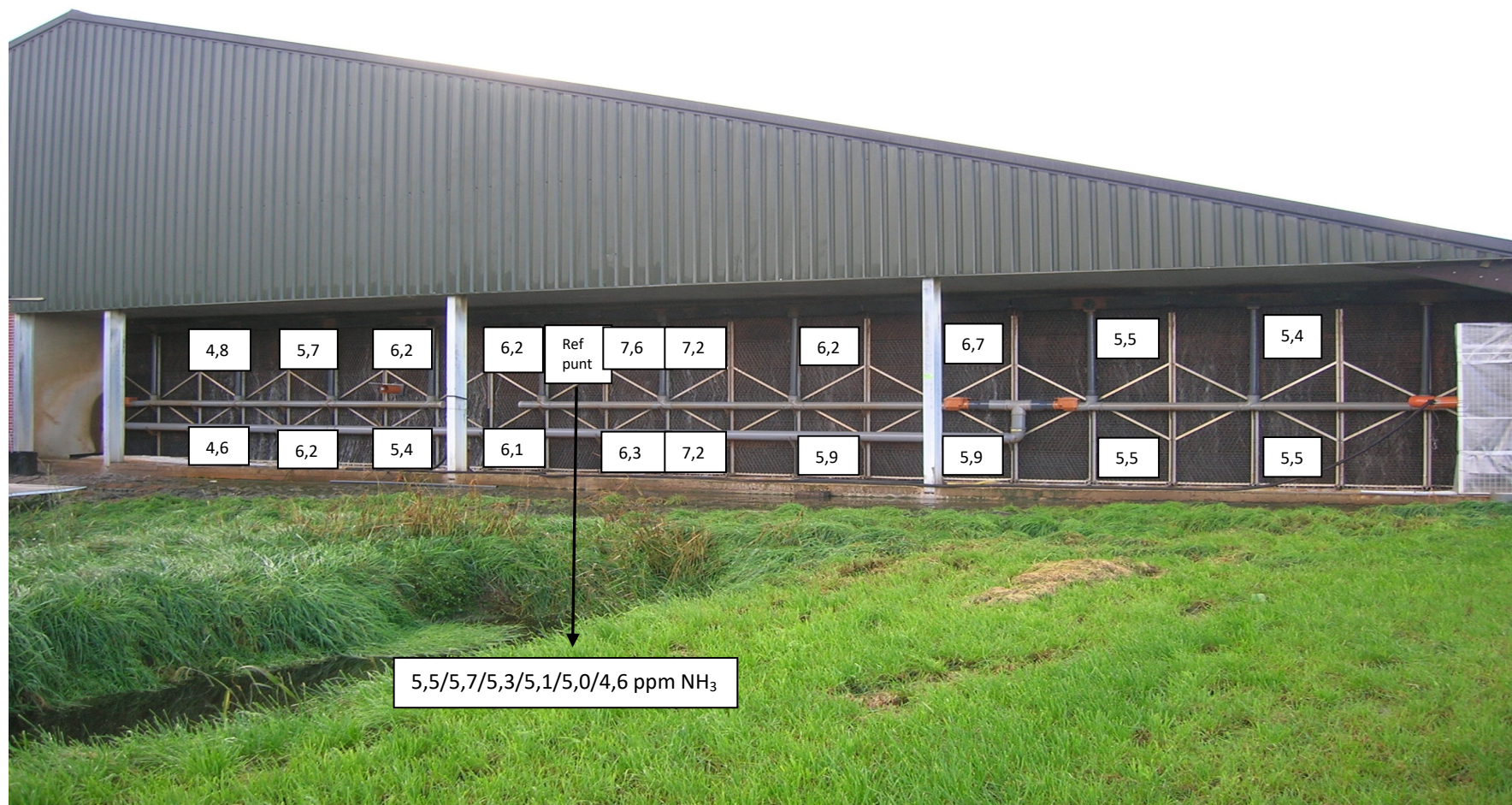
Figuur 22: Homogeniteitsmetingen bij een biologische luchtwasser te Hoogstraten
