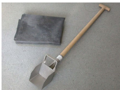
Figuur 1: bemonsteringsschep met rechtopstaande rand
