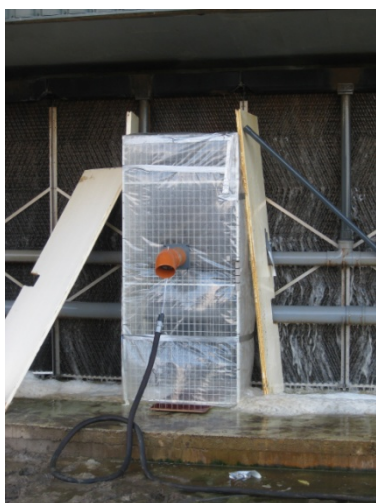
Figuur 24: NH 3 meting met box
