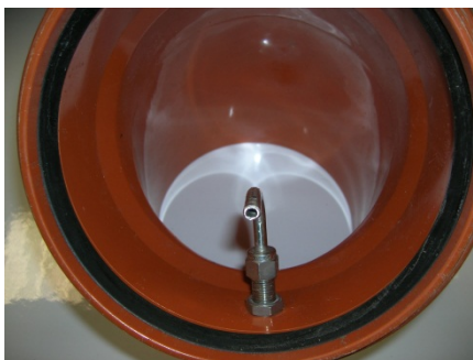
Figuur 14: Opzetstuk met aanzuigmond voor rechtstreekse aankoppeling van een verwarmde leiding zonder aanzuigsonde
