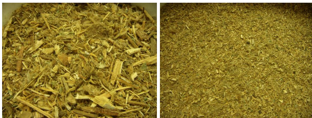
Figuur 2 Links: Houtafval (0-15 mm); Rechts: Verkleind < 2 mm
