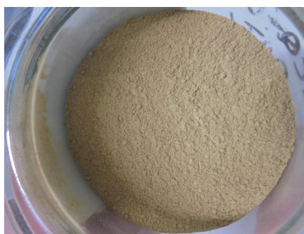
Figuur 3: Houtafval verkleind < 250 µm
