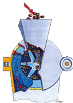
Figuur 23: Slagrotormolen (Rotor beater mill)
