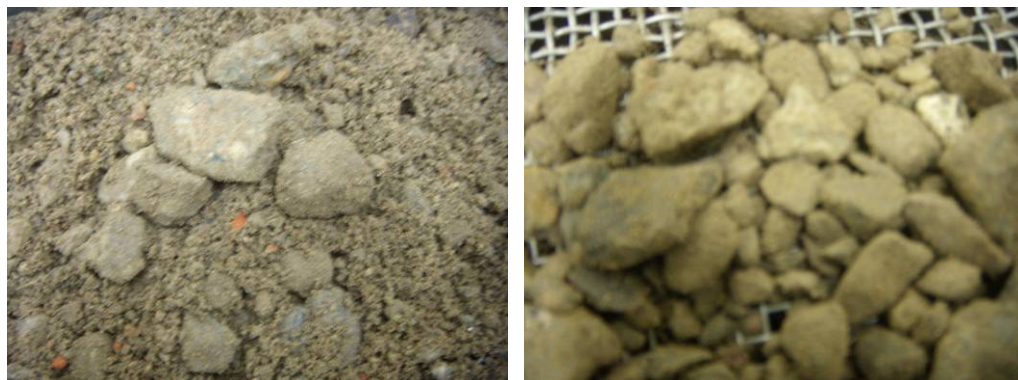
Figuur 3 Links: Betonpuin (0-20 mm); Rechts: zeefrest betonpuin groter dan 4 mm
