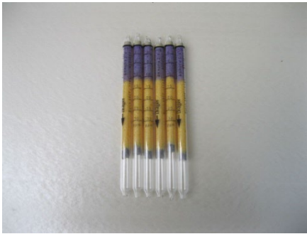
Figuur 3: Gasdetectiebuisjes voor homogeniteitscontrole van het oppervlak van de luchtwasser
