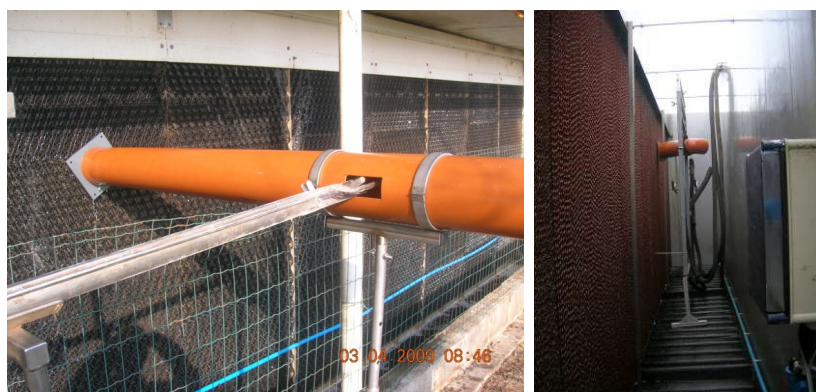
Figuur 11: Meting van de ventilatielucht aan het oppervlak van de luchtwasser met behulp van een opzetstuk
