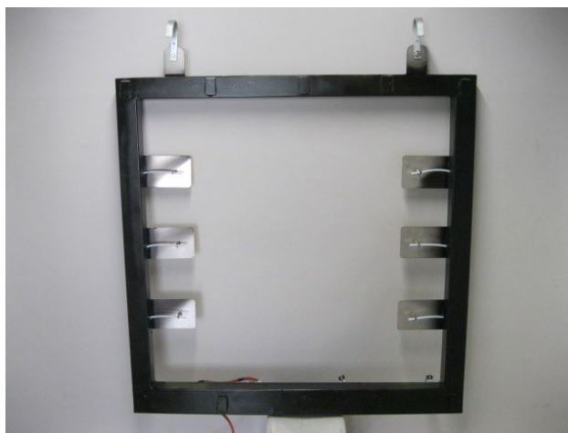
Figuur 12: Rooster voor simultane monsterneming op verschillende meetpunten van een groter deeloppervlak
