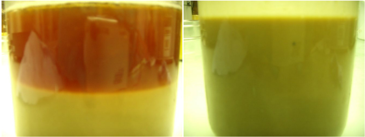
Figuur 12 Glycerine (droge stof gehalte van \pm 64\% ) – te behandelen als vloeistof: Links: origineel, rechts: na mixen
