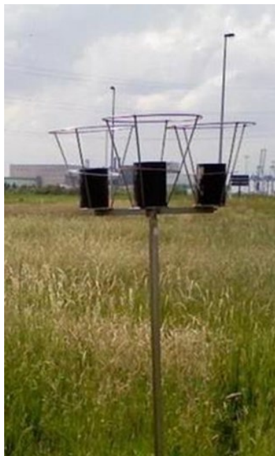
Figuur 1: Voorbeeld van een opstelling voor de monsterneming van de totale depositie aan PCDD/F's en dioxine-achtige PCB's
