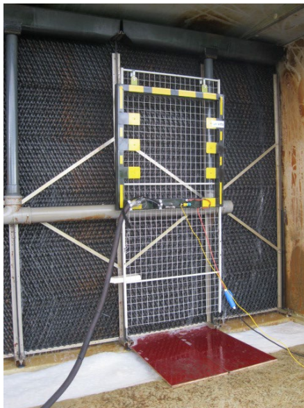
Figuur 12: Rooster voor simultane monsterneming op verschillende meetpunten van een groter deeloppervlak
