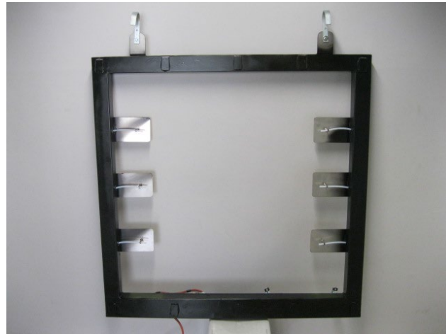
Figuur 12: Rooster voor simultane monsterneming op verschillende meetpunten van een groter deeloppervlak
