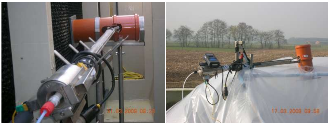
Figuur 9: Natchemische monsternemingen van NH 3 in de ventilatielucht na de luchtwasser
