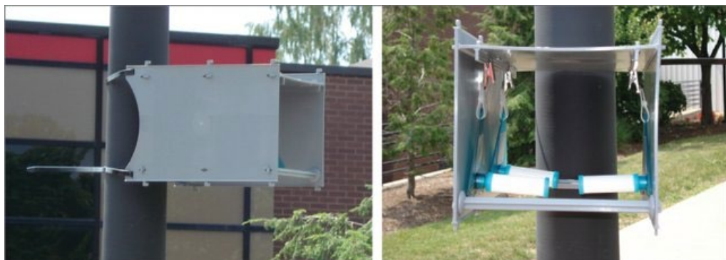
Figuur 9: Afscherming van passieve samplers bij de uitvoering van buitenluchtmetingen
