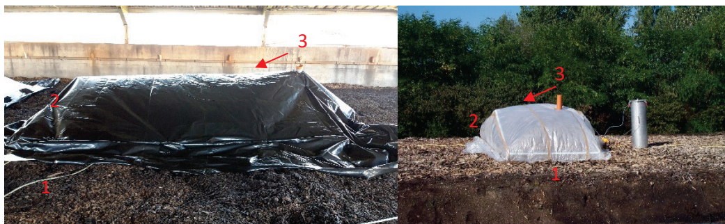
Figuur 9: Concentratiemeting aan een biofilter m.b.v. een tent
