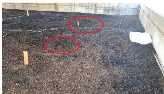
Figuur 13: Verzakkingen ter hoogte van meetpunt 4 (links) en tussen meetpunten 1, 2, 5 en 6 (rechts)
