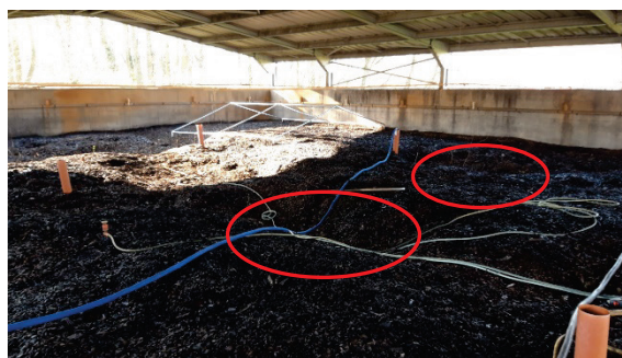
Figuur 13: Verzakkingen ter hoogte van meetpunt 4 (links) en tussen meetpunten 1, 2, 5 en 6 (rechts)
