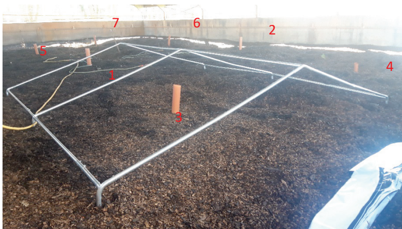
Figuur 12 : Overzicht van de biofilter met meetpunten 1 tem 7 (links: schematische voorstelling; rechts foto; getallen = nummering meetpunten door VITO)
