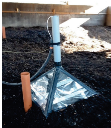
Figuur 33: Puntmeting in bestaande koker + bemonsteringshoed
