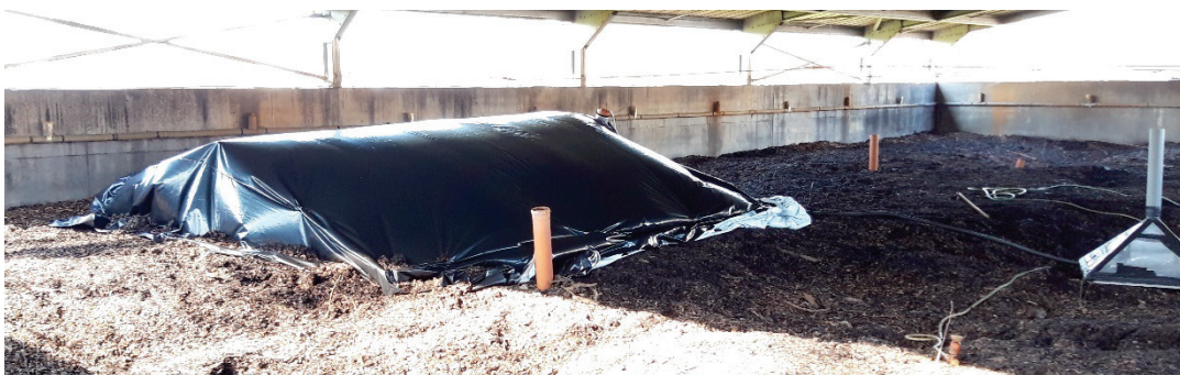
Figuur 35: Drie verschillende bemonsteringsmethoden (van links naar rechts: tent, punt/koker, hoed/kap)
