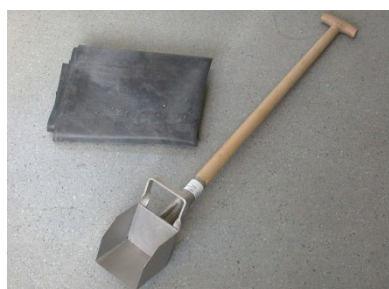
Figuur 1: bemonsteringsschep met rechtopstaande rand
