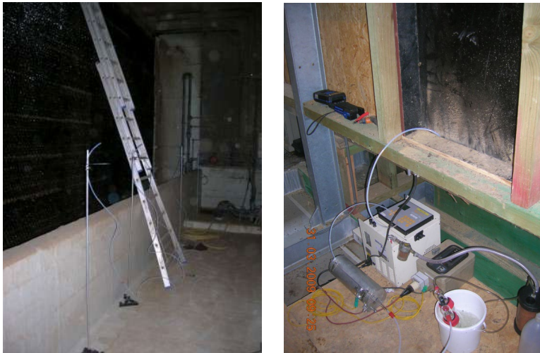
Figuur 7: \text{NH}_3 -metingen in de ventilatielucht aan de ingang van het luchtzuiveringssysteem
