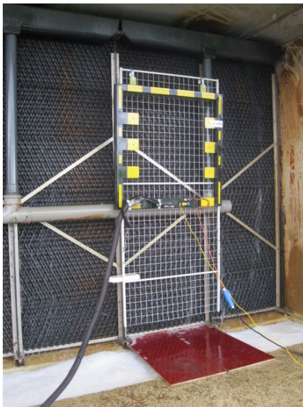
Figuur 12: Rooster voor simultane monsterneming op verschillende meetpunten van een groter deelopervlak
