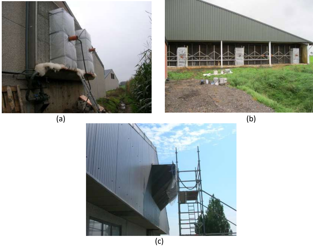
Figuur 13: Methoden voor monsterneming van grotere deelopervlakken van luchtwassystemen
