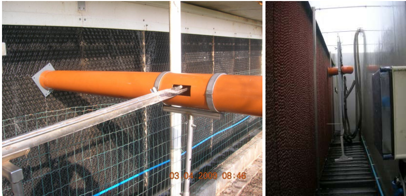
Figuur 10: Meting van de ventilatielucht aan het oppervlak van een luchtwassysteem met behulp van een opzetstuk
