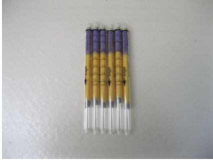
Figuur 3: Gasdetectiebuisjes voor homogeniteitscontrole van het oppervlak van het luchtwassysteem
