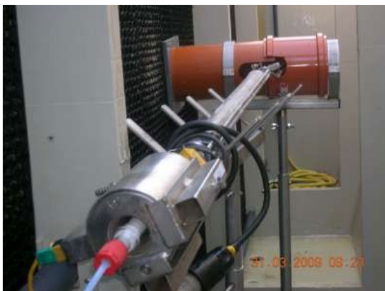
Figuur 9: Natchemische monsterneming van NH 3 in de ventilatielucht na een luchtwassysteem
