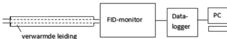
Figuur 15: Schematische voorstelling van de opstelling voor de bepaling van de koolwaterstofconcentratie
