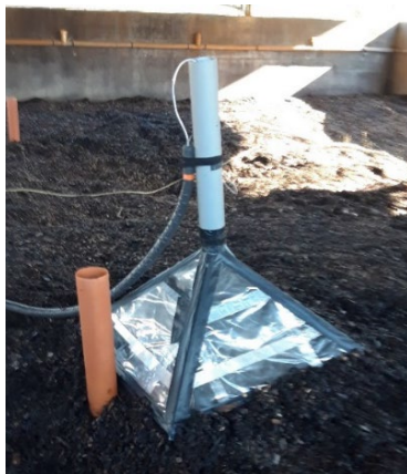
Figuur 33: Puntmeting in bestaande koker + bemonsteringshoed
