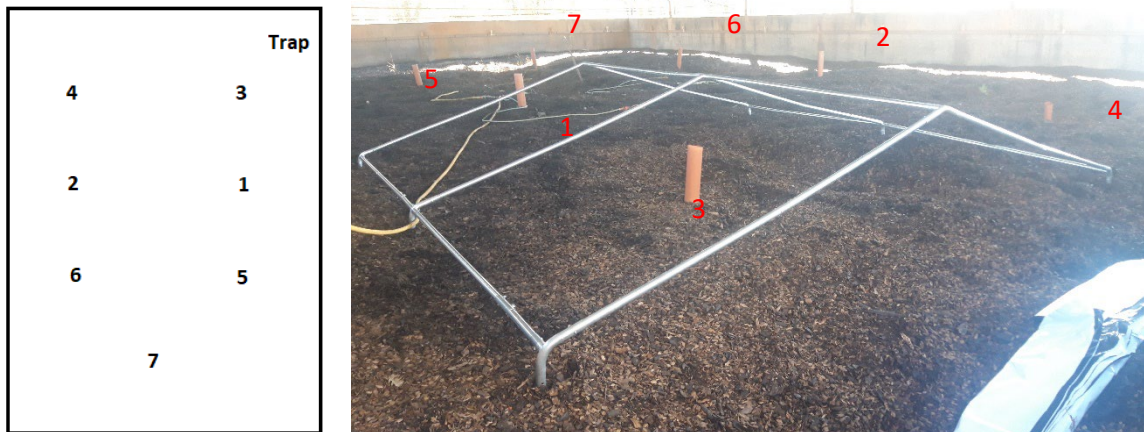
Figuur 12 : Overzicht van de biofilter met meetpunten 1 tem 7 (links: schematische voorstelling; rechts foto; getallen = nummering meetpunten door VITO)
