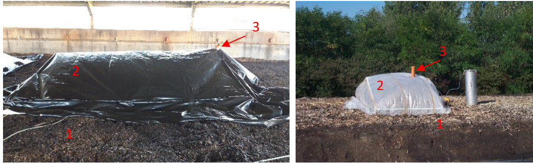
Figuur 9: Concentratiemeting aan een biofilter m.b.v. een tent
