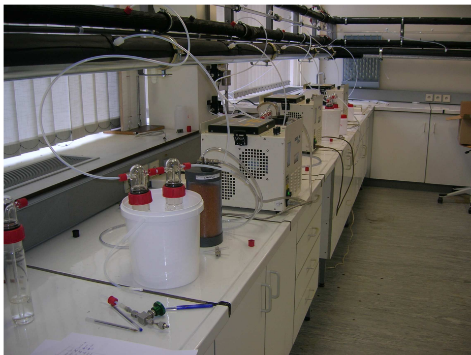
Figuur 13: Bemonsteringsopstelling van de natchemische meetmethode tijdens de laboratorium-validatietesten
