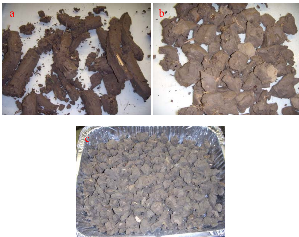
Foto 2: Bodemmonster Koksijde (40 mm) – a: origineel monster, b: grof gebroken, c: fijn gebroken
