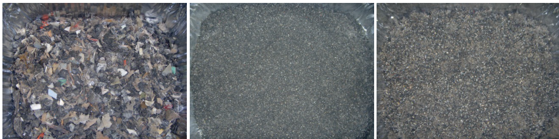
Figuur 17 Monster CIC10 (gummi fractie) – links: origineel, midden: < 1 mm, rechts: < 0.5 mm
