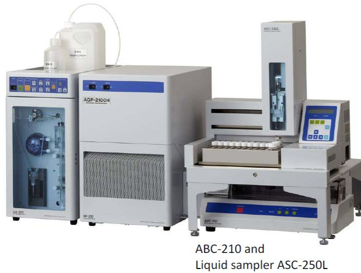
Figuur 2 : Combustion-IC systeem vloeistoffen Mitsubishi (Bron: Mitsubishi)
