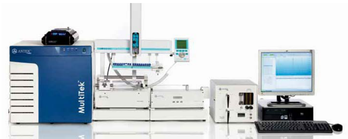
Figuur 4 : Combustion-IC-systeem vloeibare en vaste stoffen PAC (Bron: PAC)
