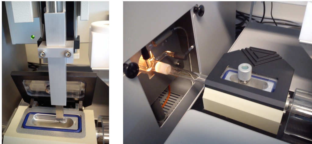
Figuur 7 (L) Plaatsen van kwarts schuitje in auto boat driver, (R) introductie in oven (Toestel: Metrohm)
