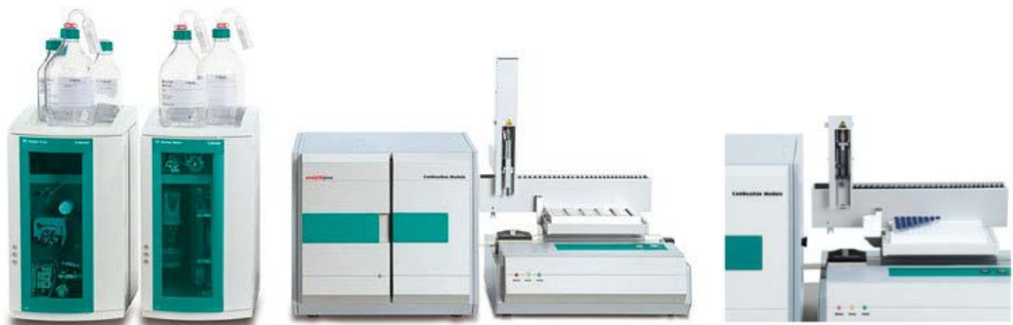
Figuur 3 : Combustion-IC-systeem vloeibare en vaste stoffen Metrohm (Bron: Metrohm)
