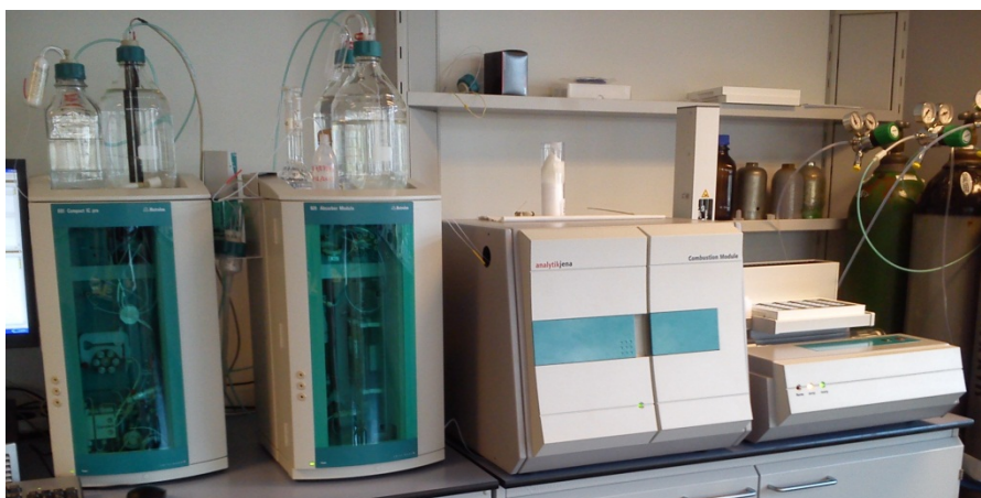
Figuur 8 Combustion-IC module van Metrohm
