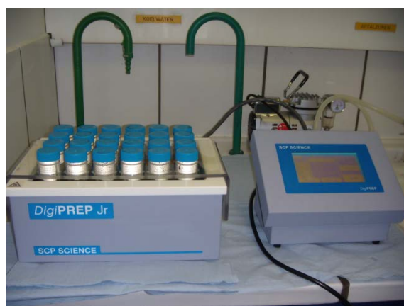
Figuur 2 Verwarmbare destructieblok met controller
