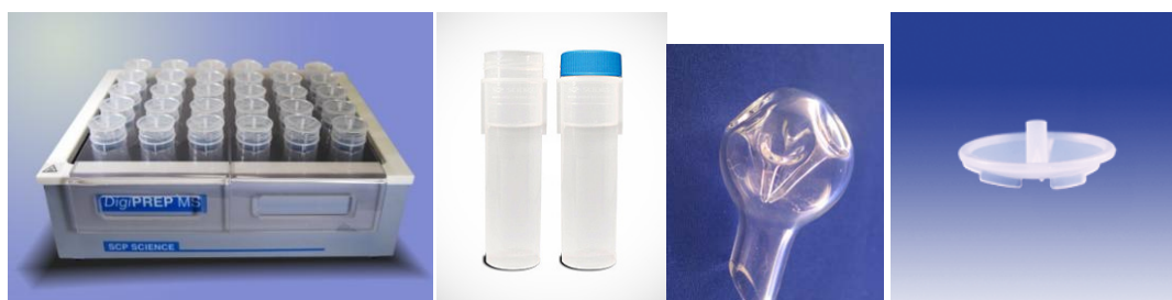
Figuur 1 (van links naar rechts): Verwarmingsblok, ontsluitingsrecipiënt, glazen bolcondensor en plastic horlogeglas
