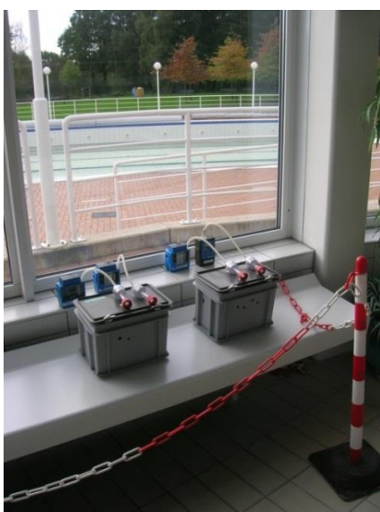
Figuur 17: Meetplaats 3 aan het recreatiebad (links meetplaats zitbank; rechts meetplaats aan de rand van het zwembad voor metingen op 40 en 150 cm boven het water)
