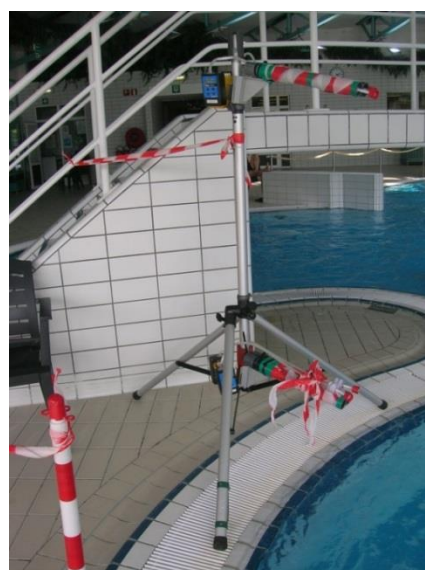
Figuur 17: Meetplaats 3 aan het recreatiebad (links meetplaats zitbank; rechts meetplaats aan de rand van het zwembad voor metingen op 40 en 150 cm boven het water)
